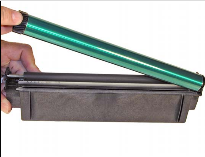
24. Remove the OPC drum.
